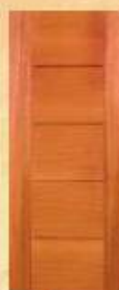
GOLF par 5: Puerta en Mdf de 4 - 5,5 - 9 mm enchapada lisa con cantería de 6 x 9mm con inserto de madera y canto de madera de 15 mm (liping)
